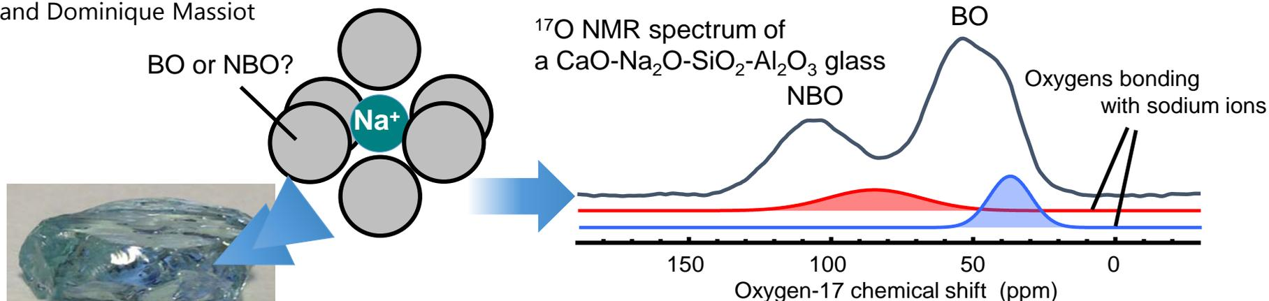
ケイ酸塩ガラス中の酸素イオンは、網目構造を構成する「架橋酸素(BO)」と網目構造の切れ目である「非架橋酸素(NBO)」に分類できる。ガラスに含まれる各陽イオン周囲に存在する酸素を定量的に分類することが、ガラス構造・物性の理解に繋がる。本研究では、二重共鳴NMR法により、多成分系酸化物ガラス中のナトリウムイオンやアルミニウムイオンが結合している酸素イオンの種類を決定することに成功した。
